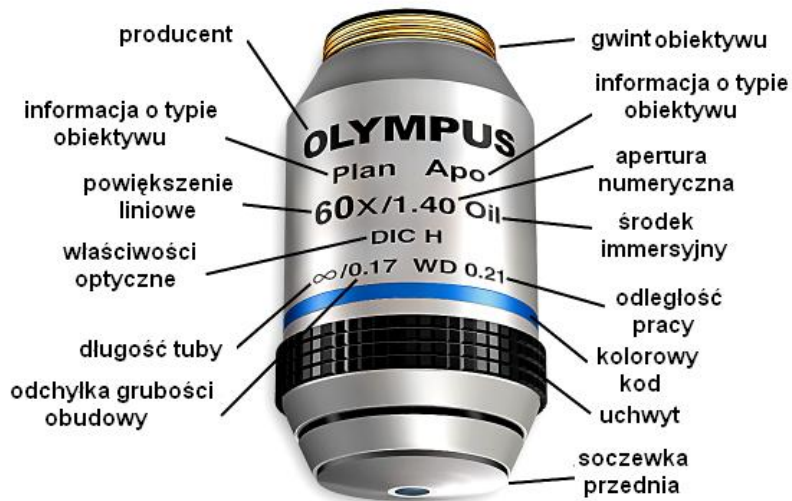
Rysunek 3 Typowy obiektyw wraz z opisem [2]
